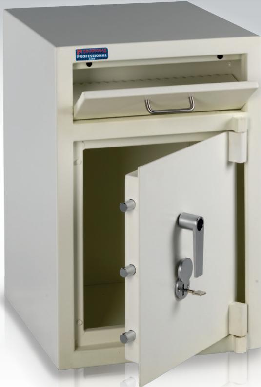
Il contenitore di sicurezza antirapina "DS/1" consente, tramite il cassetto superiore con vano basculante, il versamento dell'eccedenza di cassa direttamente nel contenitore stesso, senza doverne aprire la porta. Il cassetto consente l'introduzione e la caduta del denaro all'interno del contenitore semplicemente chiudendolo.
