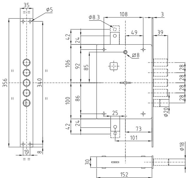
**SERRATURA AD INFILARE TRIPLICE
