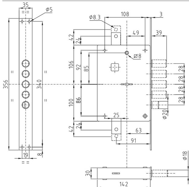
**SERRATURA AD INFILARE TRIPLICE
